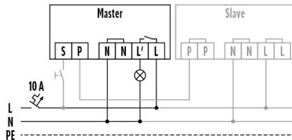
Standardbetrieb mit optionaler Ansteuerung durch Schließstaster und Verwendung von max. 10 Slave-Geräten an einem Master-Gerät.
