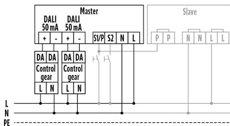
Standardbetrieb mit optionaler Ansteuerung durch Schließtaster und Verwendung von max. 10 Slave-Geräten an einem Master-Gerät.
