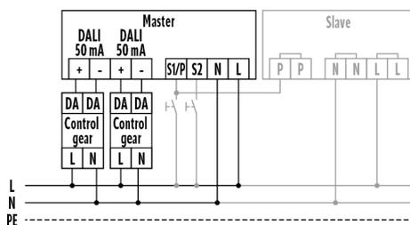
Standardbetrieb mit optionaler Ansteuerung durch SchlieBtaster und Verwendung von max. 10 Slave-Geräten an einem Master-Gerät.
