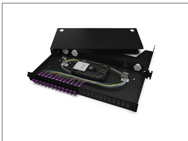
Everon® LAN1 Glasfaser Verteilerfeldgehäuse, vorbestückt mit selbstschließenden LC Duplex Adaptern und Pigtails, 12 Fasern, 1 HE, Multimode OM4, universelles Spleißpaket für Schrumpf-/Krimpspleißschutz, ohne Spleißschutz, schwarz
