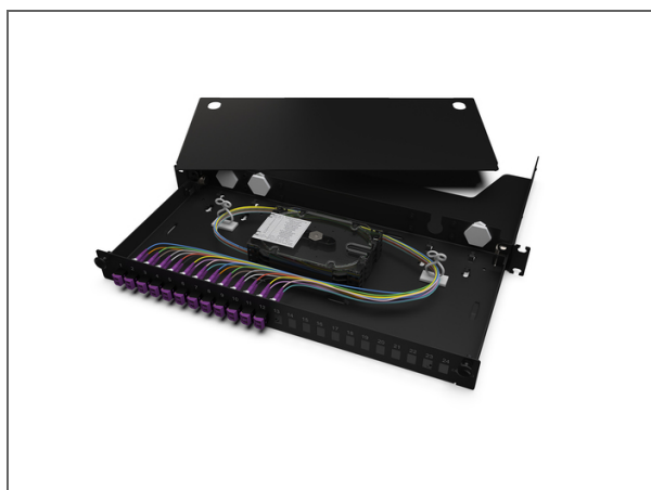
Everon® LAN1 Glasfaser Verteilerfeldgehäuse, vorbestückt mit selbstschließenden LC Duplex Adaptern und Pigtails, 24 Fasern, 1 HE, Multimode OM4, universelles Spleißpaket für Schrumpf-/Krimpspleißschutz, ohne Spleißschutz, schwarz
