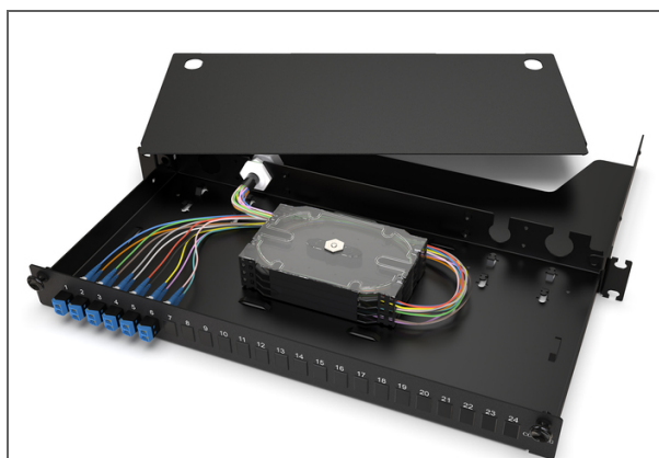
Everon® LAN1 Glasfaser Verteilerfeldgehäuse, vorbestückt mit selbstschließenden LC UPC Duplex Adaptern und Pigtails, 12 Fasern, 1 HE, SMF-28® Ultra Faser, universelles Spleißpaket für Schrumpf-/Krimpspleißschutz, ohne Spleißschutz, schwarz
