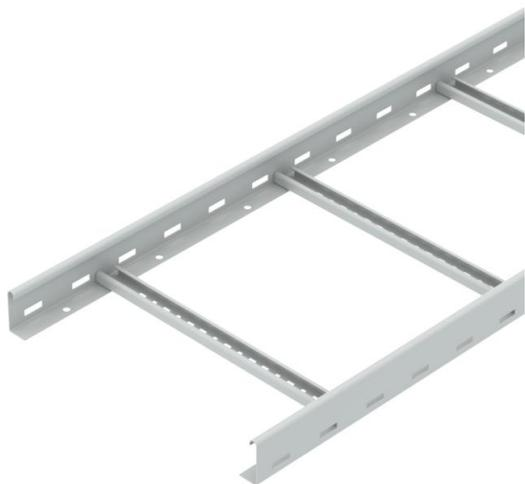
Kabelleiter mit gelochtem Seitenholm in der Seitenhöhe 60 mm mit eingieteten, nach oben offenen C-Profil-Sprossen (Ausführung VS). Die Kabelleiter wird in zusammengeklappter Ausführung geliefert. Die passende Bügelschelle vom Typ 2056 finden Sie im Abgriff Steigeleiter-Systeme.
