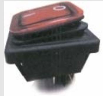
Einbau-Wippschalter Wippenbedruckung 0 - I Einbau-Wippschalter, schwarz/rot, 16 (8) A, 250V, 2-polig, Ausschalter, T120°, IP65, mit Beleuchtung und Einrastbefestigung für Ausschnitt 22x30mm, Flachsteckeranschlüsse 6,3mm, Wippenbedruckung 0- I
