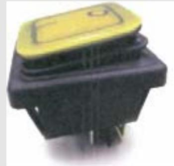
Einbau-Wippschalter Wippenbedruckung 0 - I Einbau-Wippschalter, schwarz/gelb, 16 (8) A, 250V, 2-polig, Ausschalter, T120°, IP65, mit Beleuchtung und Einrastbefestigung für Ausschnitt 22x30mm, Flachsteckeranschlüsse 6,3mm, Wippenbedruckung 0- I
