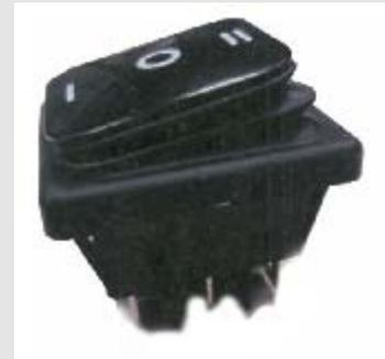
Einbau-Wippschalter Wippenbedruckung I - 0 - II Einbau-Wippschalter, schwarz/schwarz, 16 (8) A, 250V, 2-polig, Umschalter, T120°C, IP65, ohne Beleuchtung, mit Mittelstellung, Einrastbefestigung für Ausschnitt 22x30mm, Flachsteckanschlüsse 6,3mm, Wippenbedruckung I-0-II
