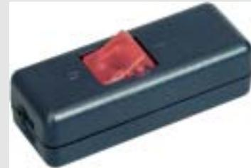
Schnur-Zwischenschalter Schnur-Zwischenschalter, weiß/rot, 10 (4) A, 250V, 2-polig, Ausschalter, Gehäuse und Zugenlastung geschraubt, Verbindungsklemme für den Schutzleiter, Kennzeichnung 0-I, Schraubkontakte für Kabel 2x0,75mm<sup>2</sup>, LBH 80x30x25mm, VDE-geprüft und beleuchtet
