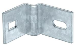
Befestigungswinkel für die Montage von IS 8-Stielen an der Wand. Die Oberfläche des Befestigungswinkels ist tauchfeuerverzinkt und wird zusätzlich nach RAL-Farbton 7032 kunststoffbeschichtet. Er kann auch in Kombination mit schwerer Steigeleiter Typ SLS 80 verwendet werden.
