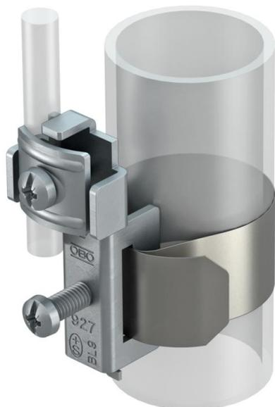
927/S-1: Banderungsschelle • Für Rohre von  $\varnothing$  3/8-1 1/2 Zoll • Anschlussmöglichkeiten: Max. 2 Leitungen 2,5-16 mm<sup>2</sup> • Rundleiter Rd 8 • Schellenkörper aus Stahl, bandverzinkt • Spannband aus rostfreiem Edelstahl (VA)
