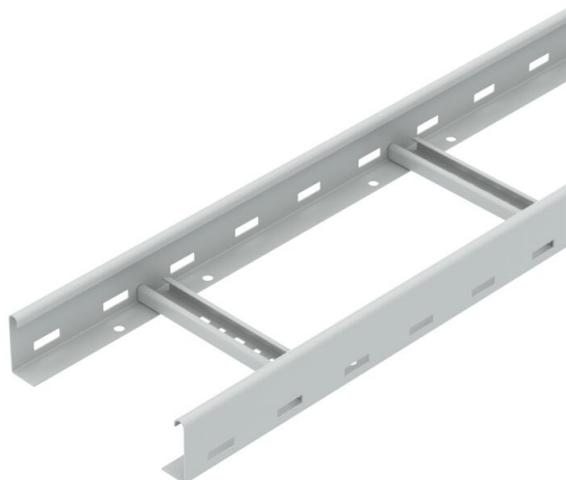
Kabelleiter mit gelochtem Seitenholm in der Seitenhöhe 60 mm mit eingieteten, nach oben offenen C-Profil-Sprossen (Ausführung VS). Die Kabelleiter wird in zusammengeklappter Ausführung geliefert. Die passende Bügelschelle vom Typ 2056 finden Sie im Abgriff Steigeleiter-Systeme.
