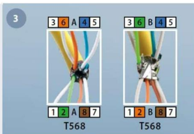
3 Adernpaare nach gewünschtem Farbcode auskreuzen, Paarschirmung auf ca. 5 mm kürzen. Arrange the wires according to the wanted colour code, shorten the pair-foils to 5 mm.
