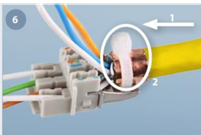
6 Adern in unteren Teil des Adernsortierers einführen und Kabel bis zum Anschlag schieben. Kabel mit Kabelbinder fixieren und bündig abschneiden. Feed the wires in the bottom part of the cable sorter and push the cable to stop. Fix the cable by using a cable strap and cut it flush.
