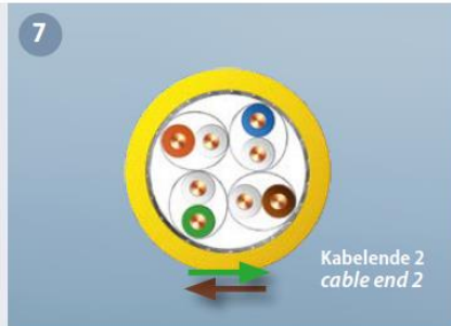
7 Auskreuzen der Kabelenden. Cross cable ends.
