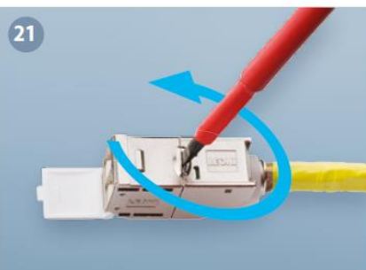
21 Bei Modultauch Schraubendreher (Größe 5) verwenden. Achten Sie darauf das Modul gerade aus dem Kabelstecker zu führen, um evtl. Beschädigungen vorzubeugen. To change the module use a screwdriver (German size 5). Please make sure the module is removed from the cable plug in a straight line to prevent possible damage.
