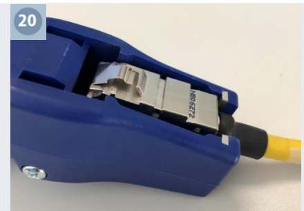
20 ... oder Buchsenmodul mit Modulverpresszange verpressen. ... or connect the socket module by using the combination pliers.
