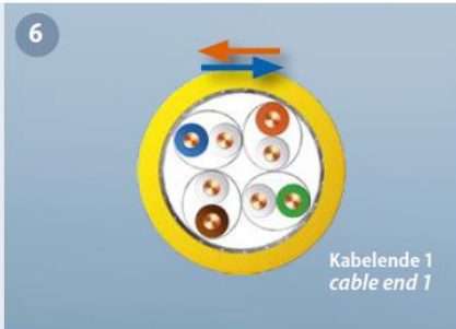
6 Auskreuzen der Kabelenden. Cross cable ends.
