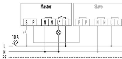
Standardbetrieb mit optionaler Ansteuerung durch Schließtaster und Verwendung von max. 10 Slave-Geräten an einem Master-Gerät.
