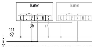
Standardbetrieb mit optionaler Ansteuerung durch Schließtaster und Parallelschaltung von max. 6 Geräten
