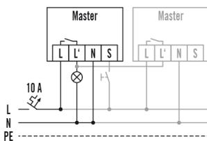
Standardbetrieb mit optionaler Ansteuerung durch Schließtaster und Parallelschaltung von max. 8 Geräten
