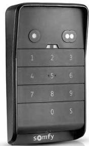
Funkcodetaster zum Steuern von bis zu zwei RTS-Antrieben bzw. RTS-Anwendungen im Außenbereich. Mit Hilfe 4- oder 6-stelliger PIN-Codes können z. B. funkmotorisierte Garagen- oder Einfahrtstore beim Nachhausekommen sicher geöffnet werden. Zugriffsverwaltung per Hauptcode für den Gesamtzugang. Zweiter Benutzercode pro Kanal zur Gewährung eines eingeschränkten Zugangs.
