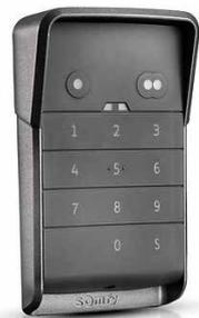
Funkcodetaster zum Steuern von bis zu zwei io-Antrieben bzw. io-Anwendungen im Außenbereich. Mit Hilfe 4- oder 6-stelliger PIN-Codes können z. B. funkmotorisierte Garagen- oder Einfahrtstore beim Nachhausekommen sicher geöffnet werden. Zu-griffsverwaltung per Hauptcode für den Gesamtzugang. Zweiter Benutzercode pro Kanal zur Gewährung eines eingeschränkten Zugangs.
