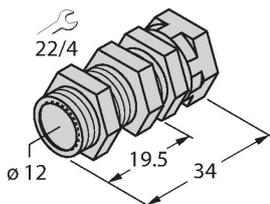
Schnellmontagehalterung mit Festanschlag; Werkstoff: Messing verchromt. Außengewinde M16 x 1. Hinweis: Der Schaltabstand der Näherungsschalter kann sich durch Verwendung von Schnellmontagehalterungen ändern
