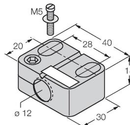
Befestigungsschelle für Gewinderohrsensoren, mit Festanschlag; Werkstoff: PA6
