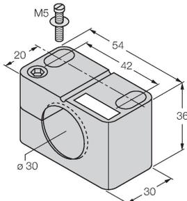
Befestigungsschelle für Gewinderohrsensoren, mit Festanschlag; Werkstoff: PA6
