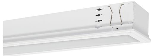
**Fassungssystem:** Fassung-Sockel-System RIDI-TUBE mit elektrischer und mechanischer Schnittstelle, verpolungssicher. Werkzeugloser Lampenwechsel über Drehrast-Mechanik, entsprechend konventionellen Leuchtstofflampen. Längsseitige Fixierung innerhalb der Fassung durch Hintergreifen auf mechanischer und elektrischer Seite.
