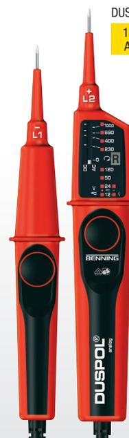
Alle DUSPOL®-Spannungsprüfer besitzen ein direktes Anzeigesystem mit geringer Belastung der Prüfstelle. Im Bedarfsfall kann ein Lastkreis über Drucktaster zugeschaltet werden, der induktive und kapazitive „Blindspannungen“ unterdrückt. Somit kann eindeutig zwischen energiereichen und energiearmen Stromkreisen unterschieden werden.
