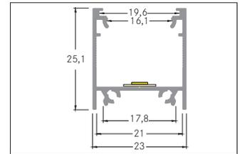
Komplett-Set Anbau-Profil 2000 mm. Abmessung Profil: L: 2.000 mm x B: 23 mm x H: 25,1 mm.
