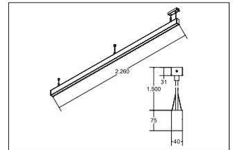
LED-Pendel-Profilleuchte direkt/indirekt BIRO40, silber, rechteckigAusführung: LED, Montageart: Pendelmontage, Montageort: Deckenmontage, Material: Aluminium / Acryl, Schutzart: nach DIN EN 60529: IP20, Schutzklasse: (EN 61140) I, Spannung: 230V AC 50Hz, Leistung: 94.9W, Lichtstrom: 11.080lm, Farbtemperatur: von 2700 K bis 6500 K, Lichtfarbe: weiß, Abstrahlwinkel: 80°, Verstellbarkeit: nicht verstellbar, mit Betriebsgerät, Art der Dimmung: DALI .
