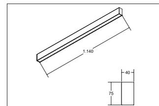
LED-Anbauprofil BIRO40, schwarz, rechteckigAusführung: LED, Montageart: Anbaumontage, Montageort: Deckenmontage, Material: Aluminium / Acryl, Schutzart: nach DIN EN 60529: IP20, Schutzklasse: (EN 61140) I, Spannung: 230V AC 50Hz, Leistung: 17.9W, Lichtstrom: 1.620lm, Farbtemperatur: 4000 K, Lichtfarbe: weiß, Abstrahlwinkel: 80°, Verstellbarkeit: nicht verstellbar, mit Betriebsgerät, Art der Dimmung: DALI .
