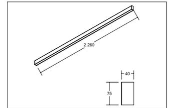
LED-Anbauprofil BIRO40, silber, rechteckigAusführung: LED, Montageart: Anbaumontage, Montageort: Deckenmontage, Material: Aluminium / Acryl, Schutzart: nach DIN EN 60529: IP20, Schutzklasse: (EN 61140) I, Spannung: 230V AC 50Hz, Leistung: 62.7W, Lichtstrom: 4.850lm, Farbtemperatur: 3000 K, Lichtfarbe: weiß, Abstrahlwinkel: 80°, Verstellbarkeit: nicht verstellbar, mit Betriebsgerät, Art der Dimmung: schaltbar .
