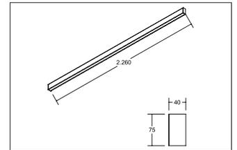
LED-Anbauprofil BIRO40, schwarz, rechteckigAusführung: LED, Montageart: Anbaumontage, Montageort: Deckenmontage, Material: Aluminium / Acryl, Schutzart: nach DIN EN 60529: IP20, Schutzklasse: (EN 61140) I, Spannung: 230V AC 50Hz, Leistung: 62.7W, Lichtstrom: 4.850lm, Farbtemperatur: 3000 K, Lichtfarbe: weiß, Abstrahlwinkel: 80°, Verstellbarkeit: nicht verstellbar, mit Betriebsgerät, Art der Dimmung: schaltbar .
