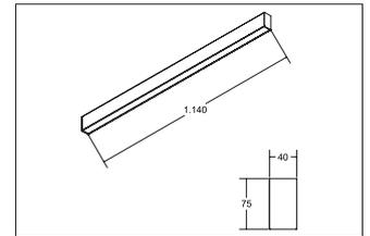
LED-Anbauprofil BIRO40, schwarz, rechteckigAusführung: LED, Montageart: Anbaumontage, Montageort: Deckenmontage, Material: Aluminium / Acryl, Schutzart: nach DIN EN 60529: IP20, Schutzklasse: (EN 61140) I, Spannung: 230V AC 50Hz, Leistung: 17.9W, Lichtstrom: 1.430lm, Farbtemperatur: 3000 K, Lichtfarbe: weiß, Abstrahlwinkel: 80°, Verstellbarkeit: nicht verstellbar, mit Betriebsgerät, Art der Dimmung: schaltbar .
