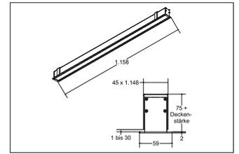
LED-Einbauprofil BIRO40, silber, rechteckig. LED-Lichtkanal mit satiniertes Abdeckung. Ausführung: LED, Montageart: Einbaumontage, Montageort: Deckenmontage, Material: Aluminium / Acryl, Schutzart: nach DIN EN 60529: IP20, Schutzklasse: (EN 61140) I, Spannung: 230V AC 50Hz, Leistung: 31.4W, Lichtstrom: 2.570lm, Farbtemperatur: von 2700 K bis 6500 K, Lichtfarbe: weiß, Abstrahlwinkel: 80°, Verstellbarkeit: nicht verstellbar, mit Betriebsgerät, Art der Dimmung: DALI .
