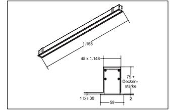
LED-Einbauprofil BIRO40, silber, rechteckig. LED-Lichtkanal mit satiniertes Abdeckung. Ausführung: LED, Montageart: Einbaumontage, Montageort: Deckenmontage, Material: Aluminium / Acryl, Schutzart: nach DIN EN 60529: IP20, Schutzklasse: (EN 61140) I, Spannung: 230V AC 50Hz, Leistung: 31.4W, Lichtstrom: 2.740lm, Farbtemperatur: 4000 K, Lichtfarbe: weiß, Abstrahlwinkel: 80°, Verstellbarkeit: nicht verstellbar, mit Betriebsgerät, Art der Dimmung: DALI .
