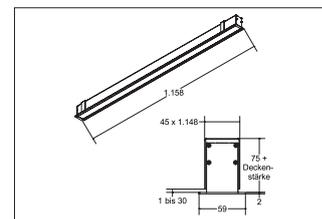
LED-Einbauprofil BIRO40, schwarz, rechteckig. LED-Lichtkanal mit satiniertes Abdeckung. Ausführung: LED, Montageart: Einbaumontage, Montageort: Deckenmontage, Material: Aluminium / Acryl, Schutzart: nach DIN EN 60529: IP20, Schutzklasse: (EN 61140) I, Spannung: 230V AC 50Hz, Leistung: 31.4W, Lichtstrom: 2.430lm, Farbtemperatur: 3000 K, Lichtfarbe: weiß, Abstrahlwinkel: 80°, Verstellbarkeit: nicht verstellbar, mit Betriebsgerät, Art der Dimmung: DALI .
