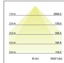
LED-Einbauprofil BIRO40, schwarz, rechteckig. LED-Lichtkanal mit mikroprismatischer Abdeckung. Ausführung: LED, Montageart: Einbaumontage, Montageort: Deckenmontage, Material: Aluminium / Acryl, Schutzart: nach DIN EN 60529: IP20, Schutzklasse: (EN 61140) I, Spannung: 230V AC 50Hz, Leistung: 35.8W, Lichtstrom: 3.030lm, Farbtemperatur: von 2700 K bis 6500 K, Lichtfarbe: weiß, Abstrahlwinkel: 80°, Verstellbarkeit: nicht verstellbar, mit Betriebsgerät, Art der Dimmung: DALI .
