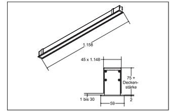
LED-Einbauprofil BIRO40, schwarz, rechteckig. LED-Lichtkanal mit satiniertem Abdeckung. Ausführung: LED, Montageart: Einbaumontage, Montageort: Deckenmontage, Material: Aluminium / Acryl, Schutzart: nach DIN EN 60529: IP20, Schutzklasse: (EN 61140) I, Spannung: 230V AC 50Hz, Leistung: 31.4W, Lichtstrom: 2.740lm, Farbtemperatur: 4000 K, Lichtfarbe: weiß, Abstrahlwinkel: 80°, Verstellbarkeit: nicht verstellbar, mit Betriebsgerät, Art der Dimmung: schaltbar .
