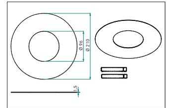
Reduzierring 210 mm, chrom, rund Reduzierring geeignet für Einbaustrahler mit Montagefedern.
