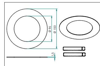
Reduzierring 150 mm, nickel matt, rund Reduzierring geeignet für Einbaustrahler mit Montagefedern.
