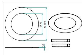
Reduzierring 150 mm, chrom, rund Reduzierring geeignet für Einbaustrahler mit Montagefedern.
