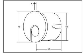
LED-Wandeinbauleuchte, für Gerätedosen, weiß, rund. Einbaumontage, Wandmontage. Zur Installation in Hohlwand- oder Betongerätedosen mit einer Einbautiefe von mind. 62 mm (Schraubabstand: 60 mm).
