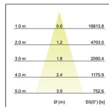
LED-Schienenstrahler, strukturweiß, rund. Ausführung in kompakter Bauform für die harmonische Implementierung in stimmige, architektonische Raumkonzepte. Wärmeableitung: passiv (ohne Lüfter), Inkl. Betriebsgerät, schaltbar, (230 V AC 50 Hz). Leuchte inkl. Euro-Adapter für Standard-3-Phasen-Schienen.
