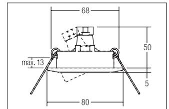
Einbaustrahler, GX5,3, nickel matt, rund. Ausgeführt in kompakter Bauform für werkzeuglose Schnellmontage zum Deckeneinbau. Ausführung: GX5,3, Montageart: Einbaumontage, Montageort: Deckenmontage, Material: Stahl, Schutzart: nach DIN EN 60529: IP20, Schutzklasse: (EN 61140) III, Spannung: 12V, Leistung: 50W, Anzahl der Leuchtmittel / Fassungen: 1.0 Stk, Verstellbarkeit: schwenkbar, ohne Betriebsgerät, Art der Dimmung: abhängig vom Betriebsgerät .
