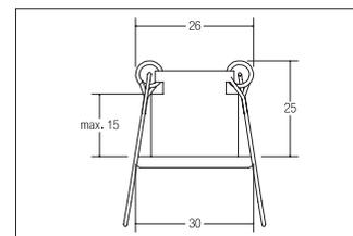
Lichtpunkt, chrom matt, rund. Ausgeführt in kompakter Bauform für werkzeuglose Schnellmontage zum DeckeneinbauAusführung: G4, Montageart: Einbaumontage, Montageort: Deckenmontage, Material: Guss, Schutzart: nach DIN EN 60529: IP20, Schutzklasse: (EN 61140) III, Spannung: 12V, Leistung: 20W, Anzahl der Leuchtmittel / Fassungen: 1.0 Stk, Verstellbarkeit: nicht verstellbar, ohne Betriebsgerät, Art der Dimmung: abhängig vom Betriebsgerät .
