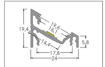
Komplett-Set Anbau-Eckprofil 1000mm, silber. Material: Aluminium, Abmessung Profil: L: 1.000 mm x B: 24 mm x H: 19,4 mm.
