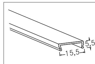
Klick-Abdeckungen: PC , opal. Material: Kunststoff, Abmessung Profil: L: 2.000 mm x B: 15,5 mm x H: 5,5 mm.
