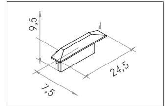
Halter-Set, aluminium. Material: Kunststoff, Abmessung Profil: L: 7,5 mm x B: 24,5 mm x H: 9,5 mm.
