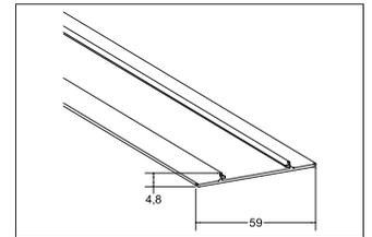
Front-Aluminiumabdeckplatte, alu eloxiert. Material: Aluminium, Abmessung Profil: L: 2.000 mm x B: 59 mm x H: 4,8 mm.
