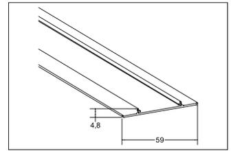
Front-Aluminiumabdeckplatte, weiß. Material: Aluminium, Abmessung Profil: L: 2.000 mm x B: 59 mm x H: 4,8 mm.
