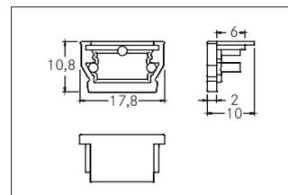
Endkappen-Set zu 53400, silber. In Verbindung mit den Profilabdeckungen 53400000 53400070 kann sowohl ein zusätzlicher mechanischer Schutz als auch eine optimale Lichtverteilung erreicht werden. Material: Aluminium, Abmessung Profil: L: mm x B: 17,8 mm x H: 10,8 mm.
