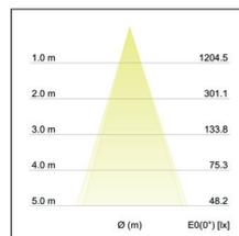
LED-Einbaustrahler, dim2warm, strukturweiß, quadratisch. Ausgeführt in kompakter Bauform für werkzeuglose Schnellmontage zum Deckeneinbau. Wird die Leuchte gedimmt, verringert sich die Farbtemperatur.
